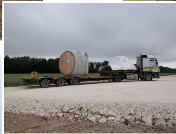
Poids nacelle : 84 t (avec rotor)
